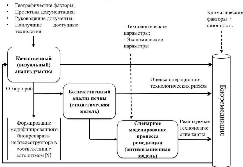
Блок-схема логико-информационной модели ремедиации нефтезагрязненных земель с межсезонным внесением биопрепаратов
